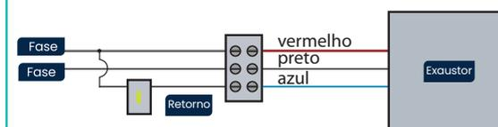
O **Ventokit** pode ser instalado em um interruptor independente ou em conjunto com o interruptor da luz do ambiente.
