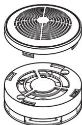
Insira a nova cápsula no lugar, garantindo que os ganchos da cápsula se encaixem perfeitamente no dispositivo.
